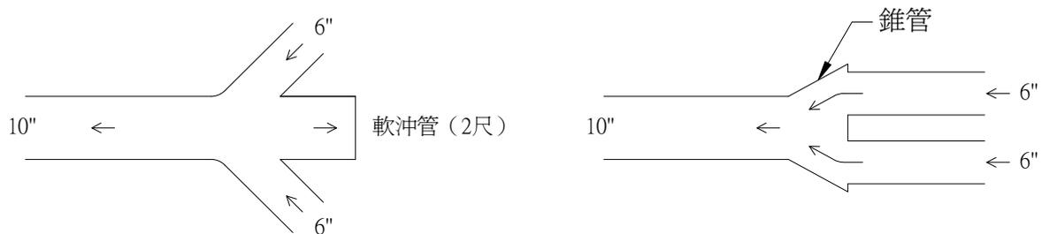
10. 若延長管之安裝延伸長度超過 20M 固定於外牆之立管安裝時必須在每兩支管子就安裝一節防震軟管，防止因排煙昇溫至 500°C 以上管路因熱脹冷縮整支排煙管掉落影響使用安全。
